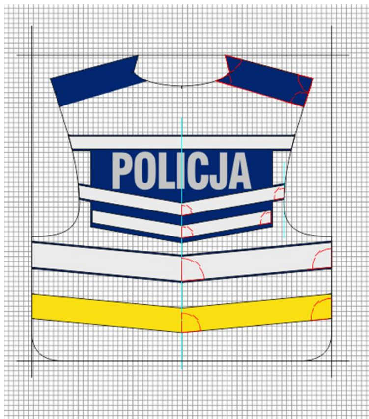
Rysunek 8. Graficzne przedstawienie odległości naszywania elementów odblaskowych i ich kąty nachylenia w przodzie kamizelki odblaskowej
