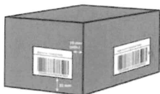
Rozmieszczenie etykiety z kodem kreskowym na jednostce handlowej niedetalicznej
